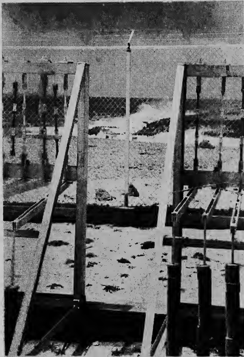
Tambe tin pruebanan special cu rekmento di plachinan di metal, manera e foto aki riba ta mustra. Aparatonan special cu diferente clase di peso ta rek plachinan di aluminium cu tambe ta den e aire liber di pekel, solo biento y frialdad.
